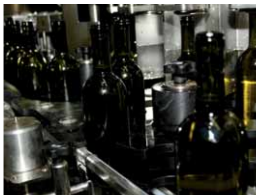
Dettaglio riempitrice della nuova linea d'imbottigliamento.
