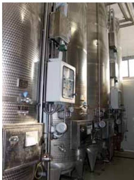
Autoclavi in uso dal 2012: serbatoi isobarici per vini frizzanti e spumanti.
